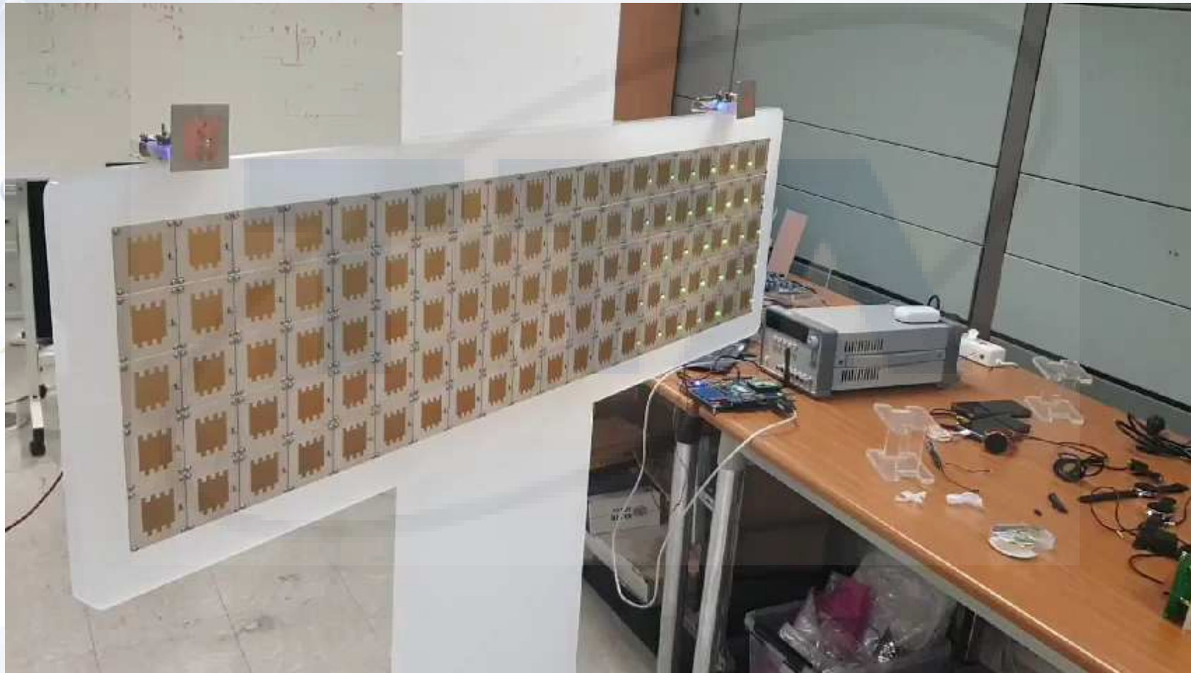
[Retro-reflective 방식의 위치 추적 전자기파 무선전력전송 시연]
